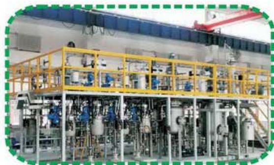
橡胶多功能溶液聚合中试装置
